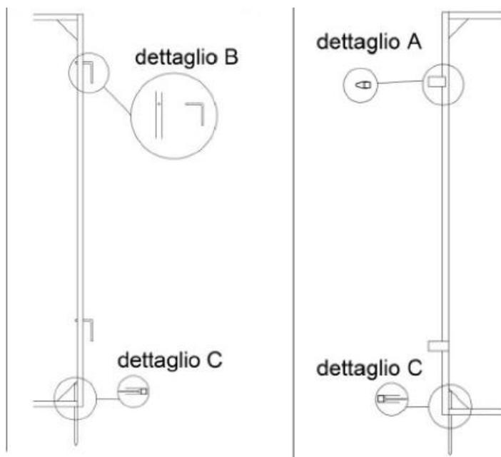
fig.3 – Particolare di dettaglio dei perni e delle asole dei pannelli.
