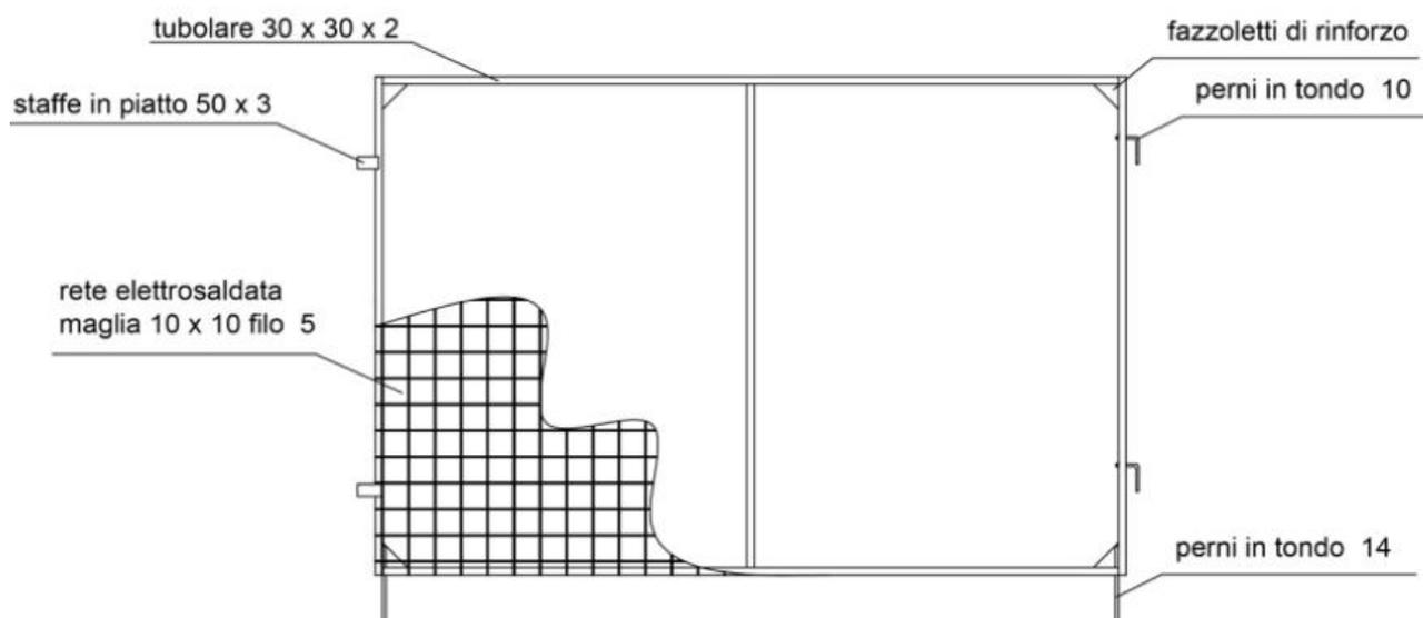
fig.1 schema esemplificativo del pannello modulo della recinzione di dimensione 2,5x 2 metri
