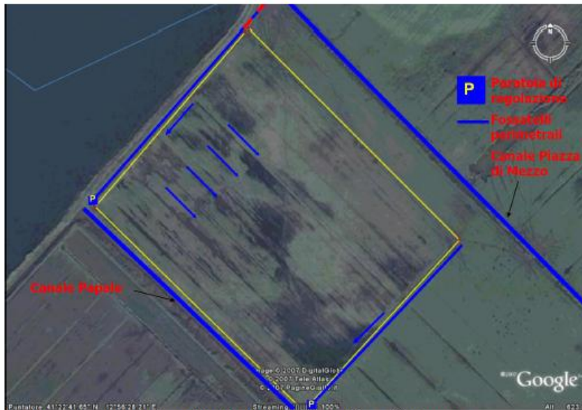
Fig.17: schema di regolazione del reticolo idrografico nell'area di intervento.
