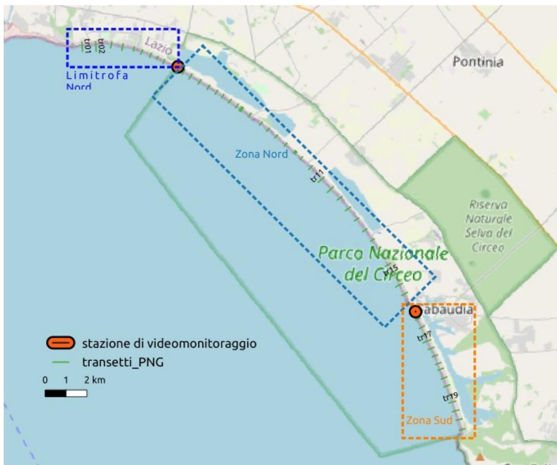
Figure 17. Aree utilizzate per analizzare il comportamento aggregato della linea di riva estratta dai dati satellitari.
