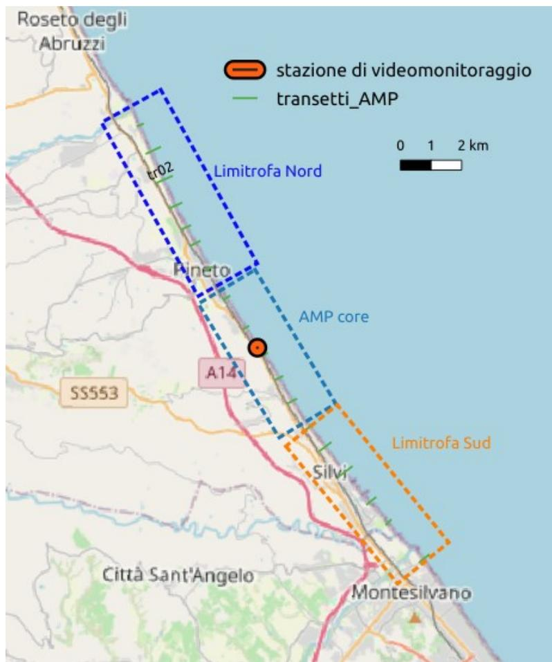
Figure 27. Areali utilizzati per analizzare il comportamento aggregato della linea di riva estratta dai dati satellitari.
